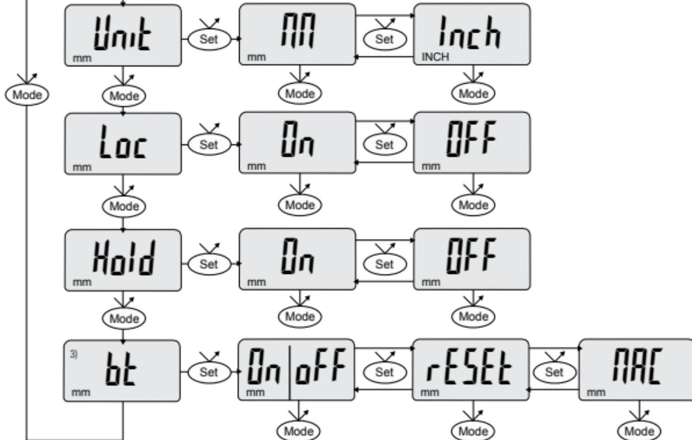
Sans pression (après 5s) : Retour au mode mesure (15s pour l'insertion du preset 27)
